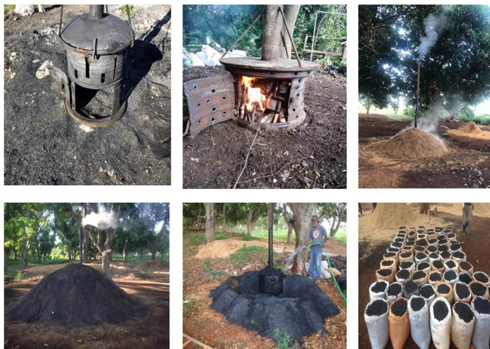
Figura 1. Proceso de obtención del biocarbón de cáscara de arroz (carboncillo) utilizando el horno artesanal descrito y ubicado en el Módulo de casas de Cultivo “La Magela”, Quivicán, Cuba / Process for obtaining rice husk biochar (charcoal) using the artisan oven described and located in the “La Magela” crops under protected condition module, Quivicán, Cuba.
